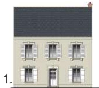
La façade sera réalisée avec un enduit à la chaux dont la couleur sera donnée par les agrégats et sables utilisés pour les constructions anciennes (avant 1948)
