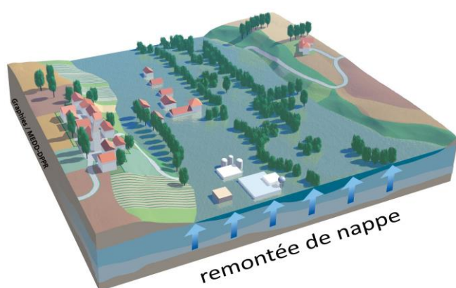
Figure 1. Inondations par remontée de nappes, source : BRGM
